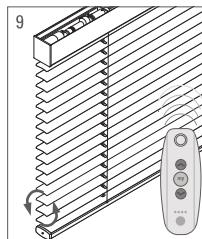
Para bascular as lâminas da Persiana, aperte com curtos intervalos o botão inferior ou superior, inclinando as lâminas até a posição desejada. (Figura 9)
