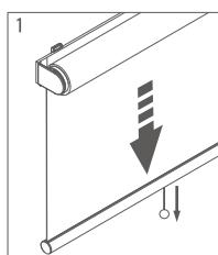
Para descer o Rolô Automático, puxe no puxador até o ponto desejado e solte-o. Há uma reserva de 200 mm no tubo, portanto, não se deve forçar o limite do tecido. (Figura 1)
