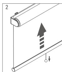
Para suspender o Rolô Automático, basta um leve toque no puxador e o tecido subirá automaticamente até o fim do curso. É importante soltar o puxador imediatamente para garantir uma subida alinhada do tecido. (Figura 2)
